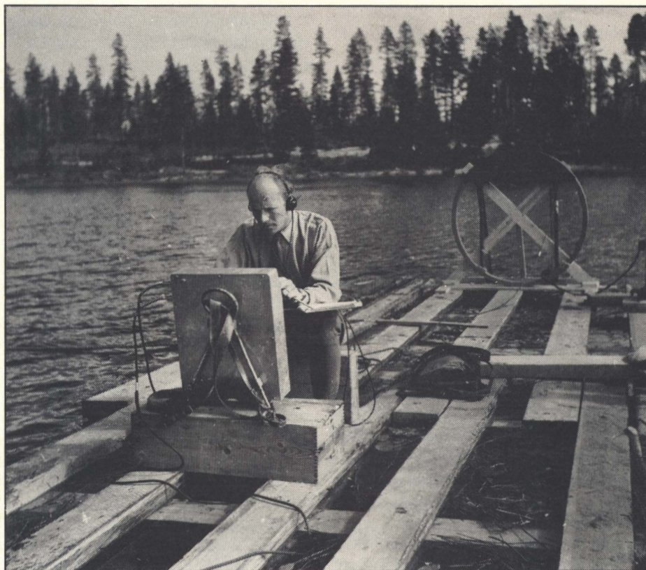
Karl-Gösta Bartoll, løjtnant ved ingeniørtropperne, arbejder på flåden i Kölmjärv. Apparatet på billedet er et malmsøgningsapparat fra Boliden. Det anvendes i et forsøg på at lokalisere metaldele på bunden af søen.
